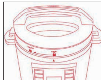
FIG. C (Posição de abertura)
